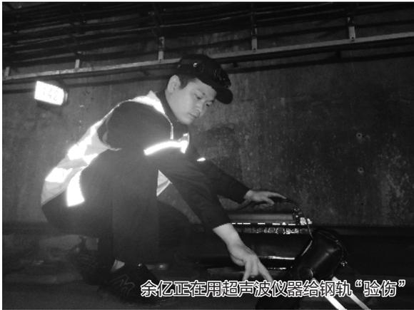
证钢轨设备质量的最后一把锁。”余亿告诉记者,钢轨探伤具有流动性大、技术性强、安全责任重的特点,是钢轨防断、确保行车安全的关键工作。
